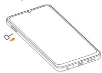
Paso 2. Retire la bandeja de la tarjeta SIM NANO/tarjeta microSD.
